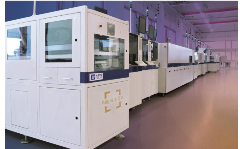
Siebdruck-Linie für die Metallisierung von Silicium-Solarzellen (Quelle: Asys Solar)
