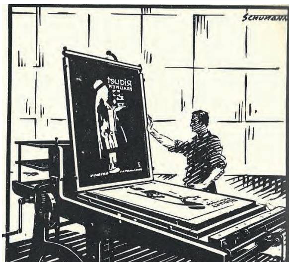
Bild 19: Das altbekannte Umdrucken = Übertragen des Druckbildes über ein Gummituch wurde der Schlüssel zum Erfolg
