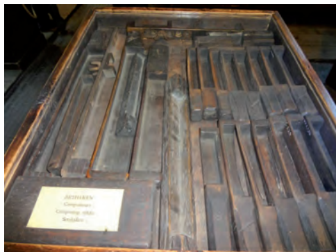
Bild 30: In solchen hölzernen Setzhaken (später metallene Winkelhaken) reihte man die Lettern zu Zeilen aneinander.
