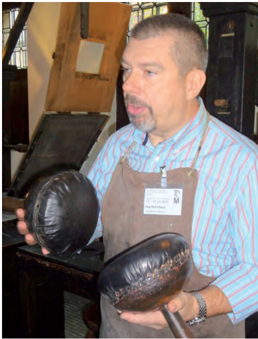
Bild 25: Mit gepolsterten Ballen und Hundelederüberzug wurde die Druckform
