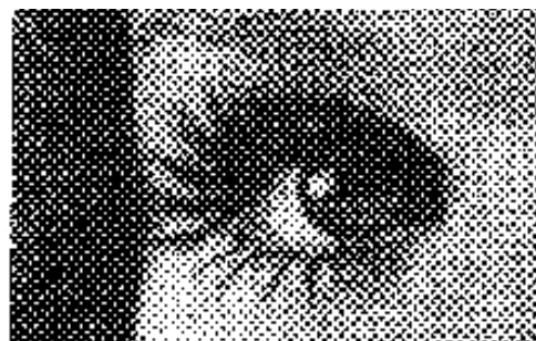
Abbildung 1: Sechsfache Vergrösserung eines Bildausschnitts: Rechts konventionelle Rasterung mit 60 L/cm, links FM-Bildaufbau mit einer Punktgrösse von 20 Mikron. Der Unterschied besteht nicht nur im Rasterprinzip, sondern vor allem auch darin, dass der FM-Bildaufbau mit sehr viel kleineren Punkten realisiert wird.
