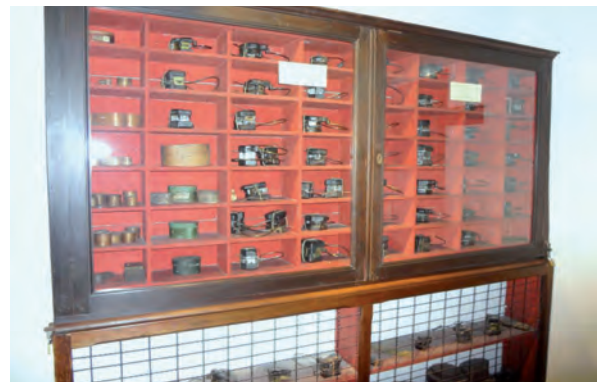
Bild 28: Johannes Gutenbergs Schrift-Gießinstrumente füllen hier einen ganzen Schrank.
