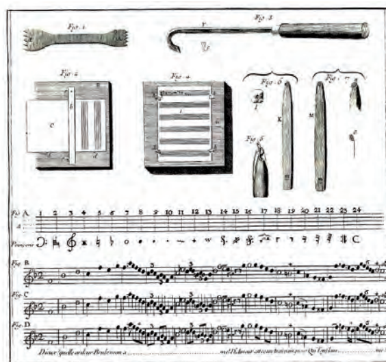
Bild 9: Die Werkzeuge des Musiknotenstechers aus der Enzyklopädie von Diderot & D'Alembert 1751-1780
